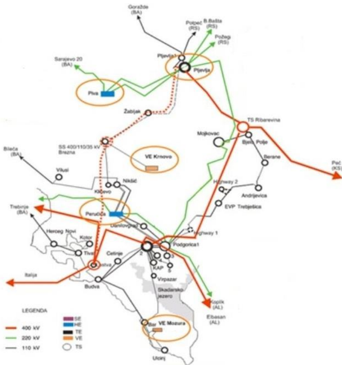
Slika 77. Detaljniji prikaz šeme crnogorskog elektroprenosnog sistema.
